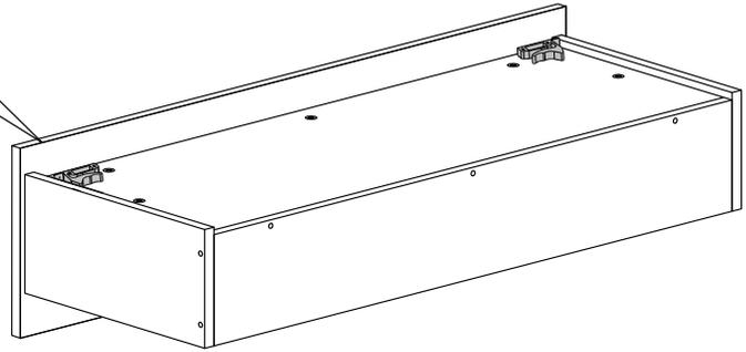
2. Фиксаторы, левый и правый, располагаются на дне ящика, закрепляются саморезами с фасадом и с боковыми стенками ящика.
