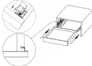
4. Регулировка фасада по вертикали. Поворачивая регулировочное колесо, отрегулируйте фасад по высоте.
