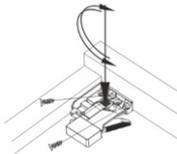
5. Демонтаж ящика. Нажимайте одновременно на рычажки фиксаторов и снимите ящик с направляющих.
