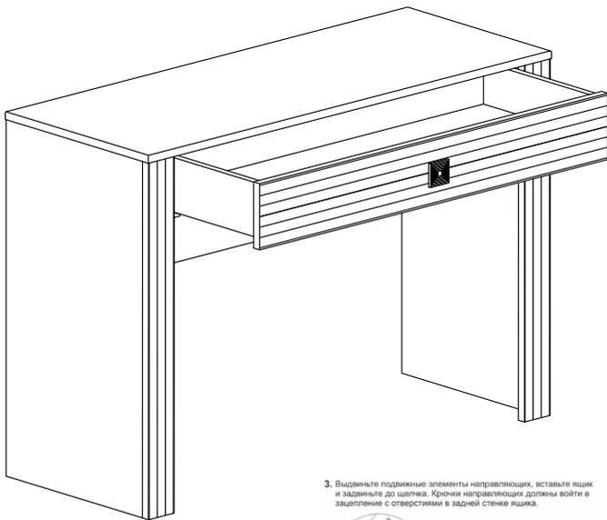
3. Выдвиньте подвижные элементы направляющих, вставьте ящик и задвиньте до щелчка. Крючки направляющих должны войти в защелкивание с отверстиями в задней стенке ящика.
